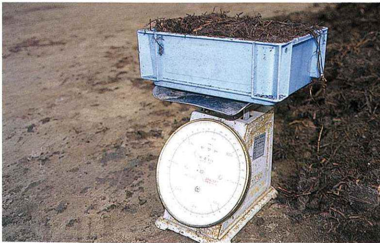
写真9 容積比重の測定
