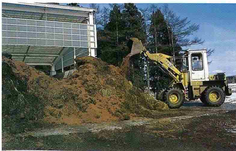
写真10 副資材の投入
