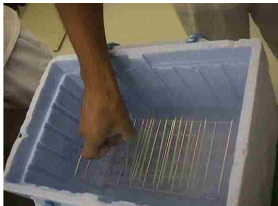
④ 液体窒素の蒸気で凍結。中の架台は試験管立て。
