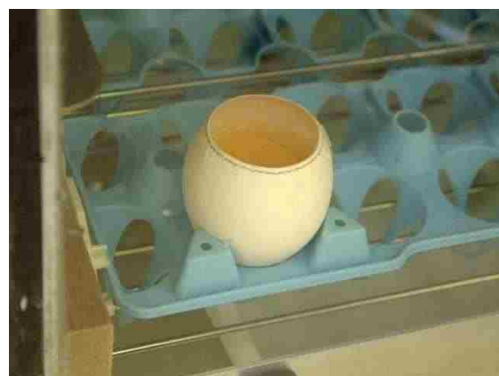
⑫ P-008 型ふ卵器に入れた所。卵トレーを3つに切断し、裏返して転卵装置にセットする。
