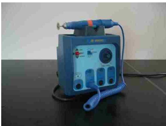
① 精密グラインダー。ミニター株式会社（東京）のスタンダードロータリー。ダイヤモンドディスクは、A5134。
