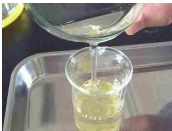
④ 採取した水溶性卵白をビーカーに移す。ある程度の量になったら、ビーカーから三角フラスコに移す。
