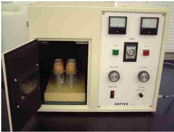
⑦ 軟X線照射装置 E-3 ソフテックス株式会社 3.5cm 程度の台に 50ml のトールビーカーを置き 20 秒間照射する。これによって胚の発生が約 1 日遅れる。
