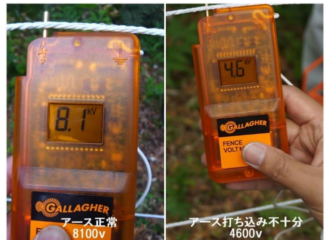
(写真3)同じフェンスでもアース不良では電圧が上がらない
