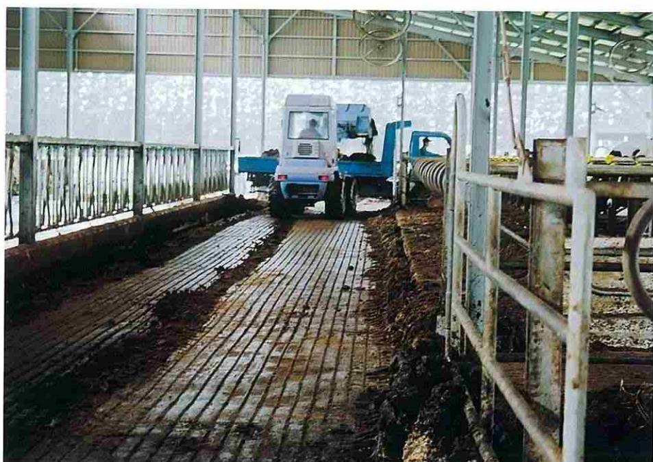
写真16 縦溝仕上げコンクリート面での更褥作業
