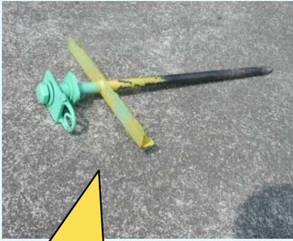
繫牧用杭。鉄棒にアングル等を溶接して自作。
