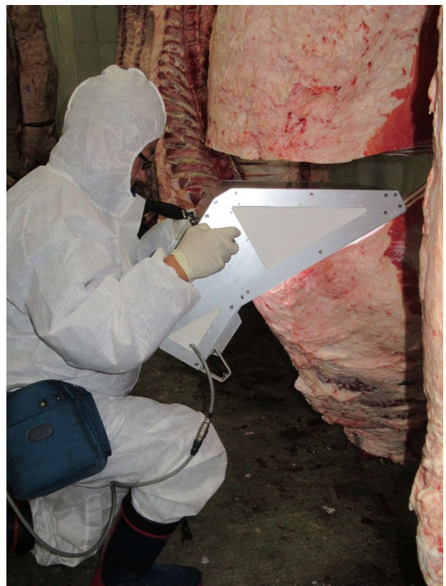
牛枝肉撮影装置（早坂理工）を用い、枝肉切開面をデジタル撮影しているところ。ミラーを介し、LEDによる均一な光量の下、常に一定距離を保って撮影が出来る様工夫されている。得られた高解像度の画像データは、専用の画像解析ソフトウェアを用いデータ処理される。
