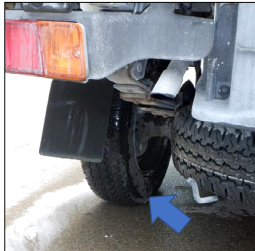
写真4：タイヤの外側からのみ消毒薬をかけた場合の内側の様子
