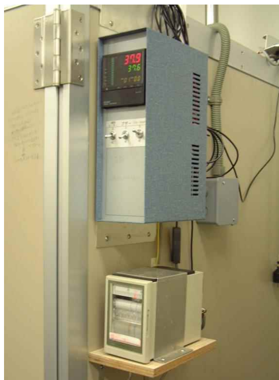
村井ふ卵器に加温処理調節部を設置 加温処理調節部は、昭和フランキ製。 この場合もふ卵器に補助ヒーターを設置。
