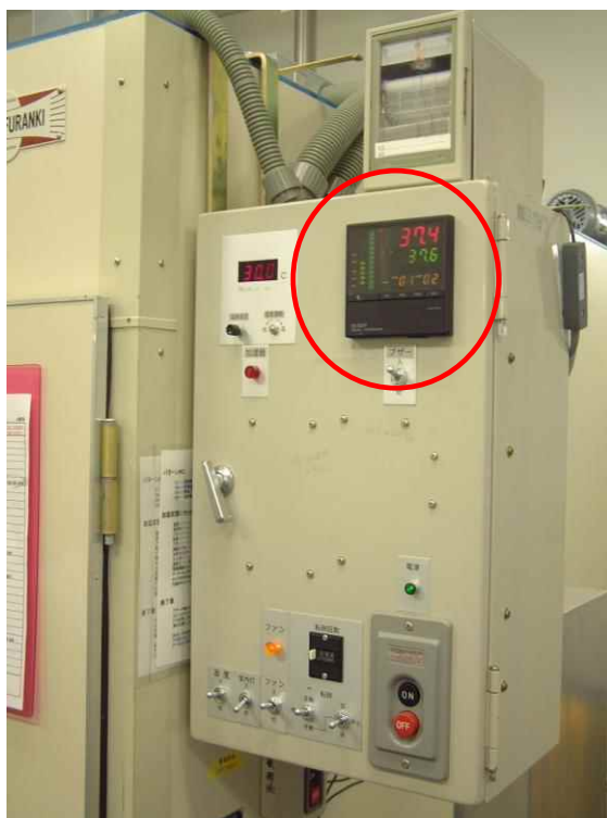
昭和フランキ製セッターの調節部分 赤丸部分が温度プログラムの調節部 ふ卵器内には、補助ヒーターを設置する。
