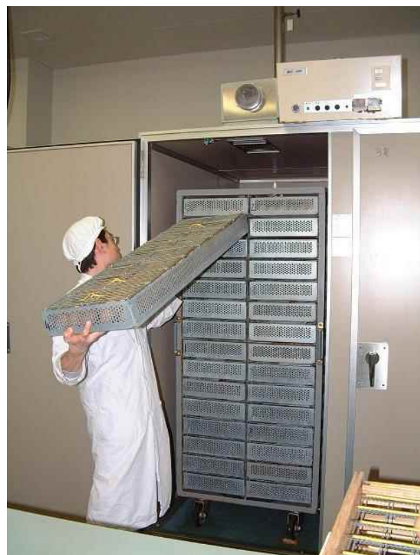
④ 発生座をハッチャーへ入れる
