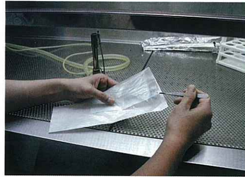
図10 クリーンベンチ内での開封 滅菌袋A及び小試験管には直接触れない ように滅菌済みのピンセットを使用する
