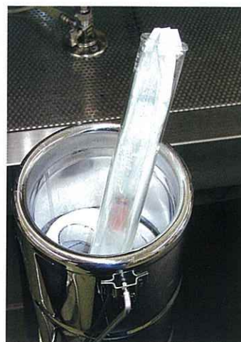
図14 胚を入れた保温容器 39℃の温湯を入れて使用している。 温湯は2時間後には約37℃になる。
