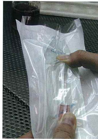
図12 蓋をする 滅菌袋A及び小試験管には直接 触れないようにする
