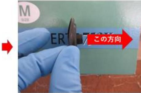
新しいダイヤフラムを写真の方向で設置する。
