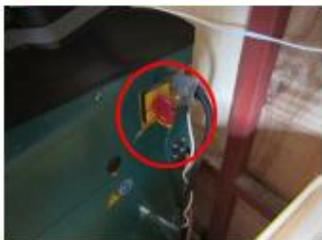
ロボット本体の電源を切る
