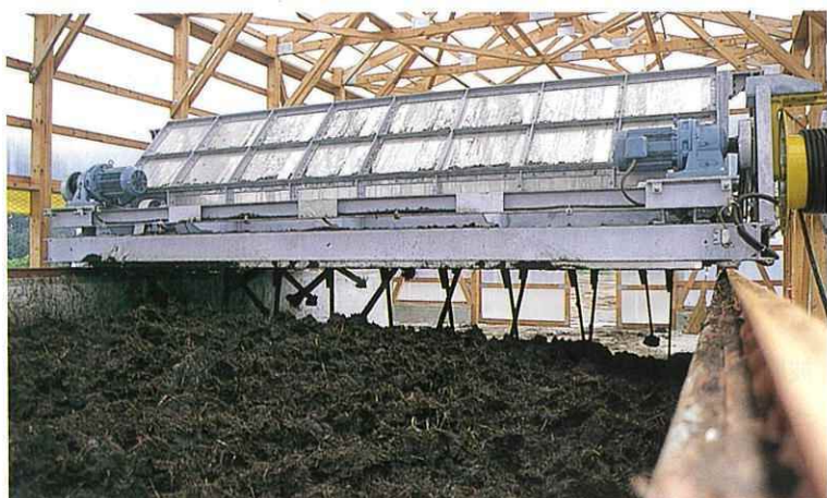
写真5 ロータリー式攪拌機
