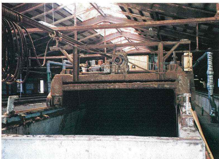
写真6 スクープ式攪拌機
