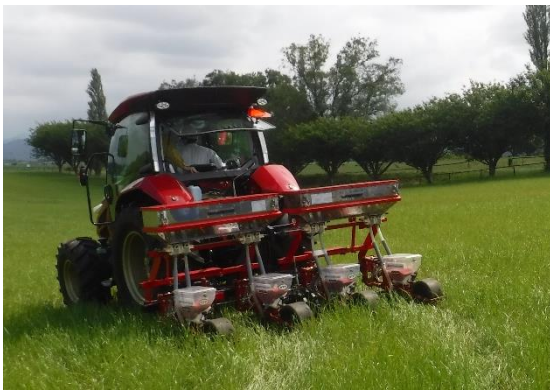
写真①:自動操舵システム及び不耕起播種機搭載のトラクターにて播種を行う様子(R4.6.22)
